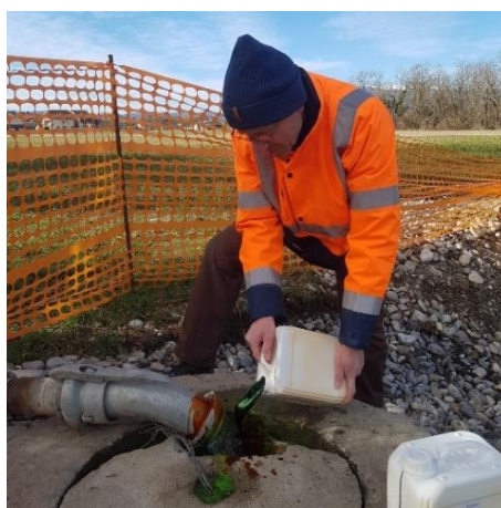
Figure 13 : Photographie de l'injection de fluorescéine dans le puits d'infiltration
