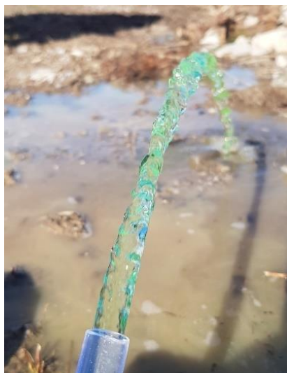
Figure 17 : Photographie de l'arrivée du colorant (fluorescéine) dans le puits P1 le 23.02.2022
